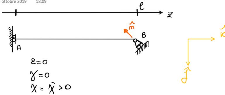
Il sistema è costituito da una trave piana vincolata attraverso un carrello nel punto B ed un glifo nel punto A. È definito un sistema di rinforzimento locale per la trave di cui sono indicati i versori  $\hat{j}$  e  $\hat{k}$  della base intrinseca.
