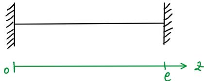
Le misure di deformazione assegnate sono:  $\varepsilon(z) = a \left(1 + \frac{z}{l}\right)$ ,  $\gamma = 0$ ,  $\chi = b$ . Combinando queste espressioni con la definizione stessa delle misure di deformazione (ovvero  $\varepsilon = w'$ ,  $\gamma = v' + \varphi$ ,  $\chi = \varphi'$ ) ed integrando si ottengono le seguenti espressioni:
