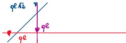
Analogamente, per la struttura in figura 2 si ottiene il seguente poligono delle forze. Il giunto bilancia la forza esterna applicata mentre l'asta obliqua non reagisce.
