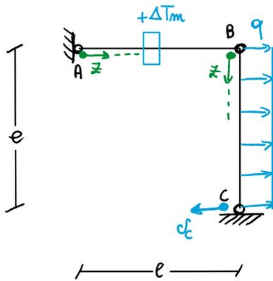
La struttura riportata in figura è un arco a tre carniere (2 travi e 3 carniere non allineate), quindi è una struttura ipostatica. Il valore delle caratteristiche della sollecitazione dunque non è influenzato dalla presenza del cedimento circolare in C o della variazione termica uniforme presente sul tratto AB.
