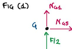
Imponendo l'equilibrio del nodo 1, tenendo conto che  $\vec{N}_{41} = -\vec{N}_{14}$  per il principio di azione e reazione, si ottiene chiudendo il poligono delle forze (FIG 2)  $N_{12} = -F/2$  e  $N_{15} = \frac{F\sqrt{2}}{2}$ .
