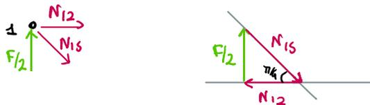
Ripetendo la stessa operazione per il nodo 2 (FIG 3) si ottiene  $N_{25} = -F$  e  $N_{23} = -F/2$ .
