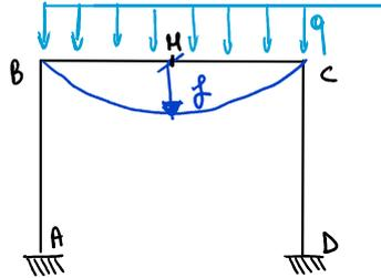
Si sceglie come sistema virtuale il seguente sistema, che ha il vantaggio di essere ipostatico e di avere solo una forza che compie lavoro proprio sullo spostamento richiesto. Si assume che tutte le strutture siano inestensibili ed indeformabili al taglio. Si riporta anche il diagramma di struttura libera del sistema.
