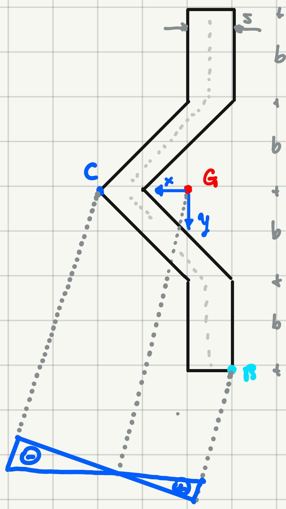
Dall'isoparale del diagramma dello sforzo normale emerge che il punto C è il più flessitoto della sezione.
