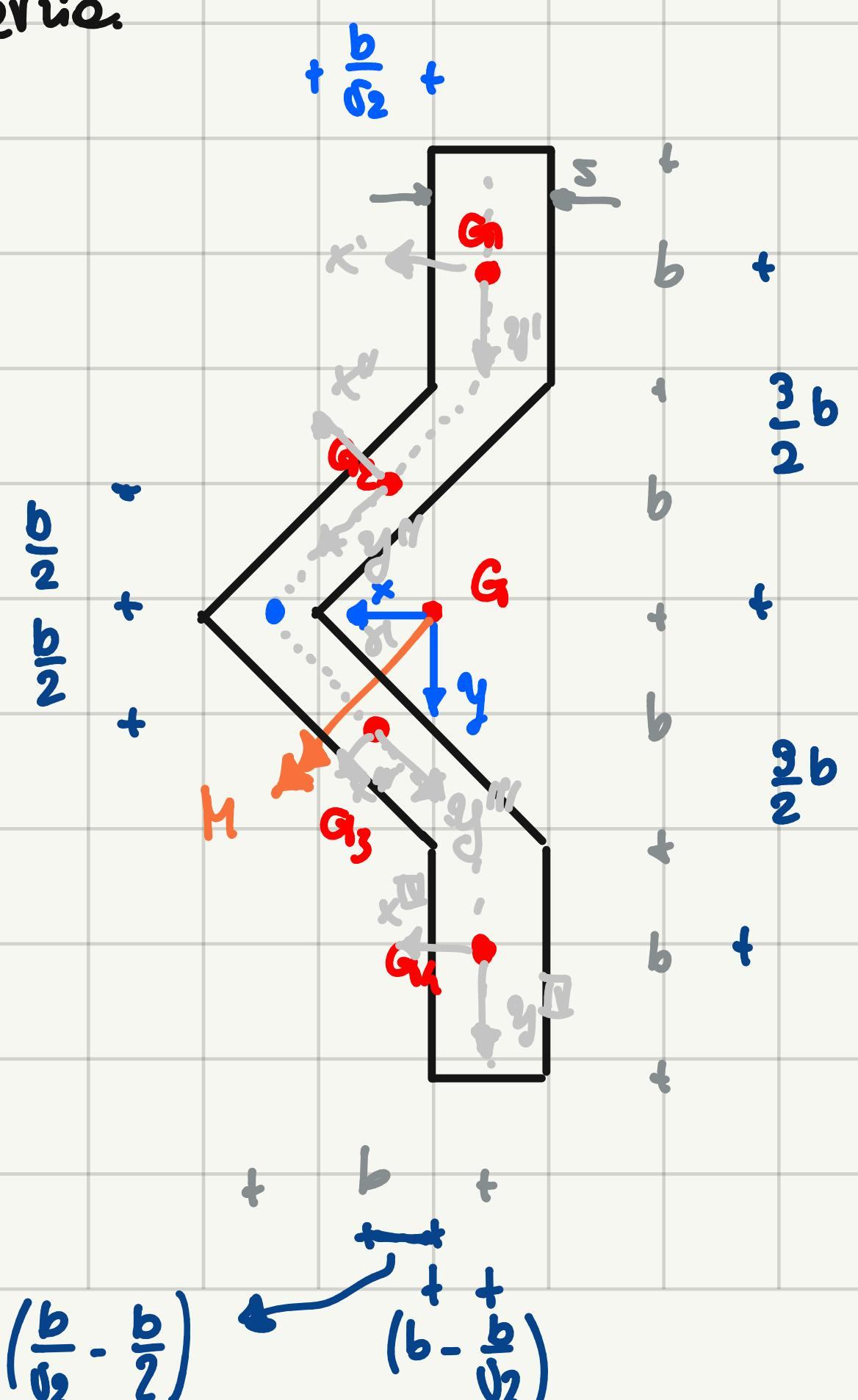
Adesso andiamo a quotare tutte le posizioni delle sottosezioni dello scivolo serio. introducendo anche dei sistemi di riferimento centrali locali alle sottosezioni.
