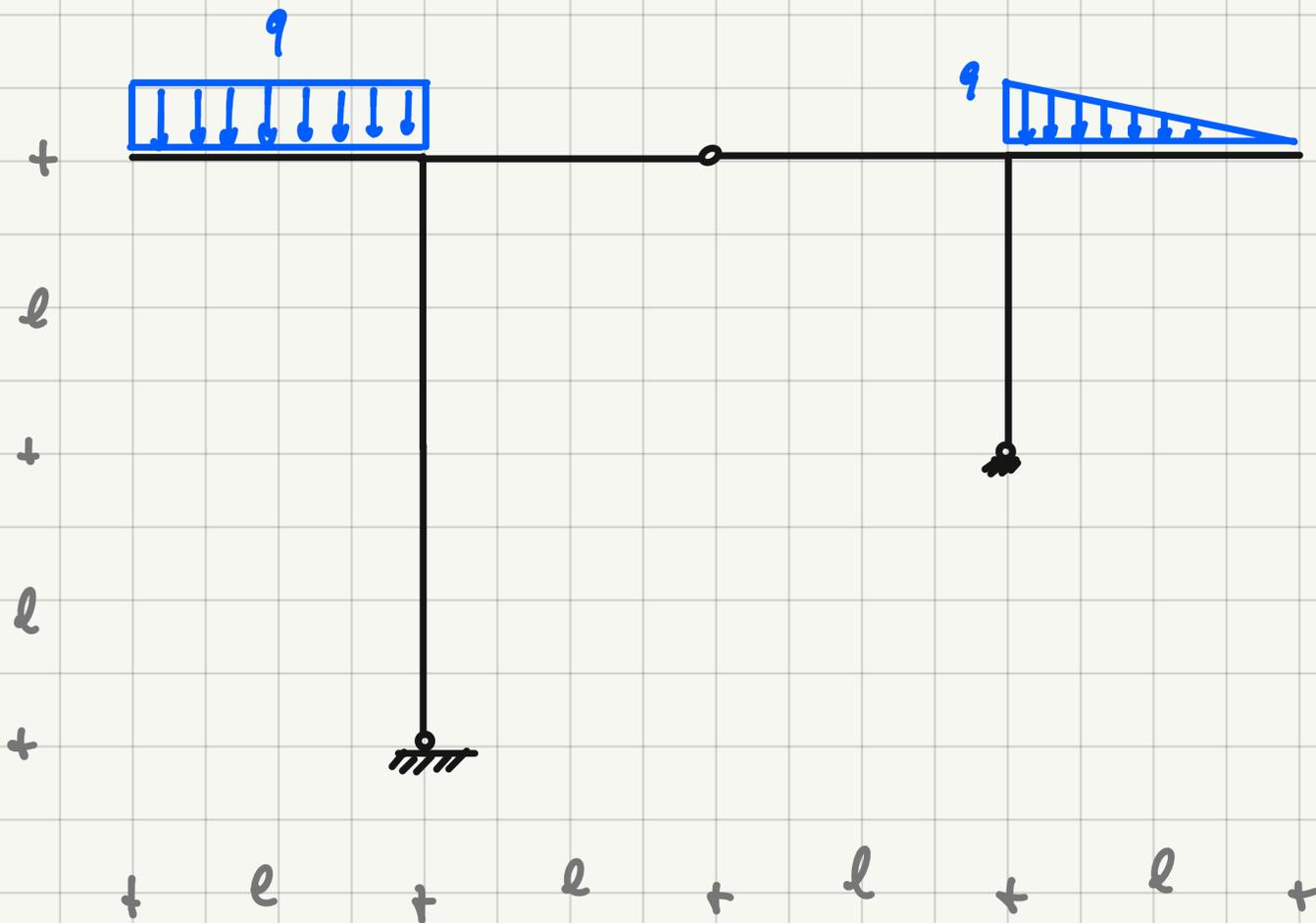
In via del tutto arbitrariamente possiamo dire che la struttura è costituita da due corpi rigidi vincolati a terra mediante delle cerniere e vincolati tra di loro mediante una cerniera interna.
